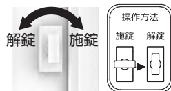
サムターン(左吊元の場合) ラベル
