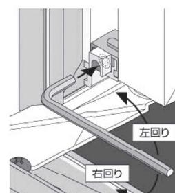
上下2箇所の縦すべり出し金物は、左右方向の調整により戸先の上下調整が可能です。
